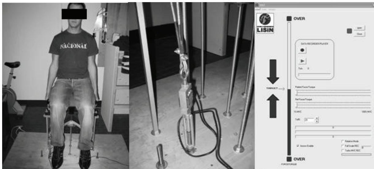
Figura 1: da sinistra, sistema meccanico per la misura della forza; dettaglio delle celle di carico; schemata principale del programma per la registrazione dei dati.
