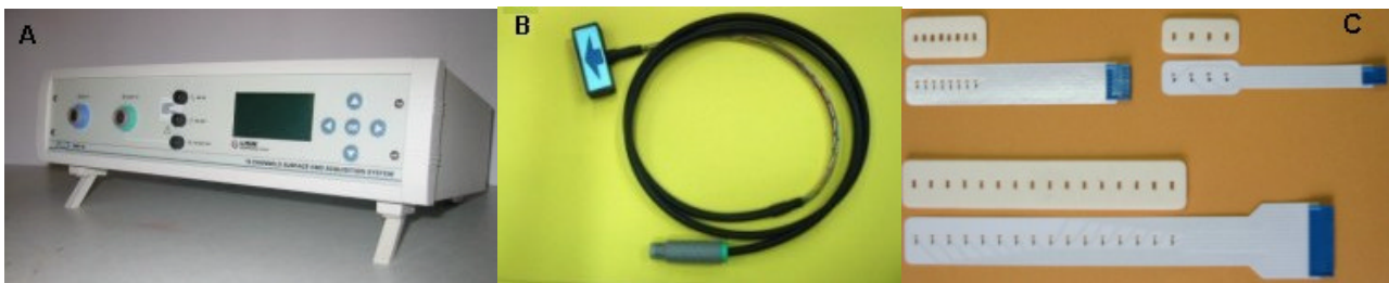
L'elettromiografo multicanale EMG 16 (A), tre diversi tipi di schiere adesive a 16, 8 e 4 elettrodi (B) e un adattatore attivo (C) a 16 canali per schiere adesive, schiere ad elettrodi di argento o sensori specifici quali sonde uretrali e rettali (non mostrate).
